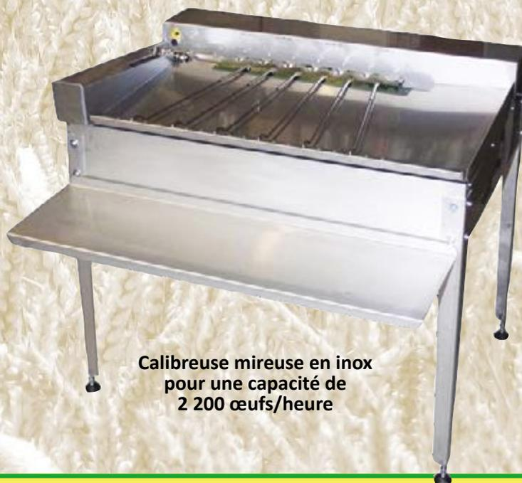
Calibreuse mireuse en inox pour une capacité de 2 200 œufs/heure
